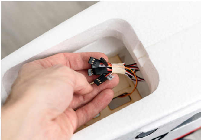
Die Kabel zum Empfänger sind gebündelt und beschriftet
