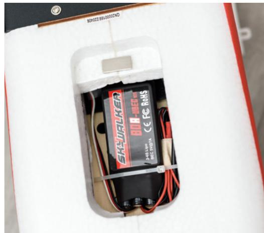
Der 80-Ampere-Regler stammt von Hobbywing. Er wird im Betrieb nur leicht warm
