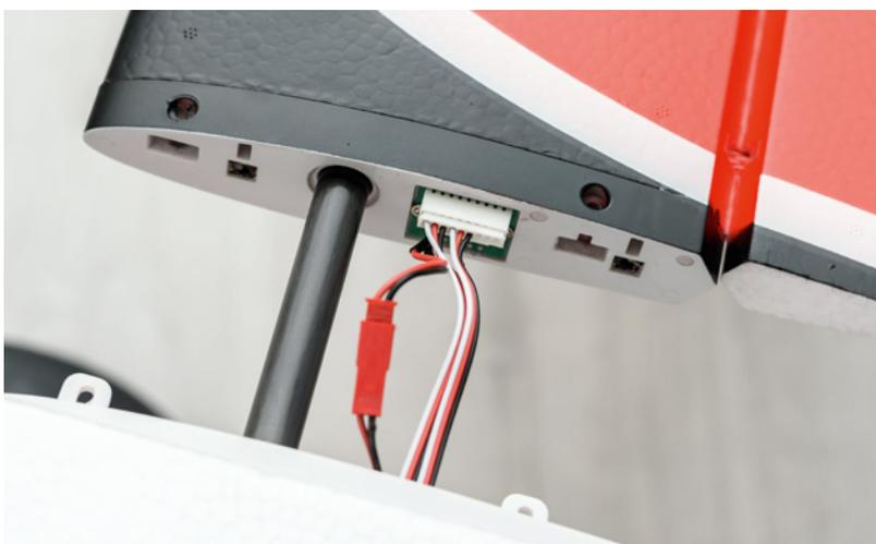
Die elektrische Verbindung zwischen Tragflächen und Rumpf erfolgt über Stecker. Der rote Anschluss ist für die Beleuchtung
