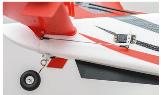
Die Höhenruderanlenkung kann sich in Extremfällen verbiegen. Es ist daher sinnvoll, sie an ein bis zwei Stellen zu stützen
