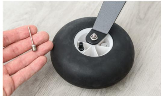
Die Luftreifen lassen sich über einen einfachen Ballpumpenaufsatz befüllen
