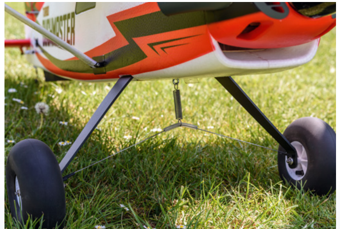
Mit einem alten Fahrrad-Bowdenzug, zwei Crimp-Ösen und einer Feder aus dem Baumarkt erhielt das Fahrwerk mehr Spannung und kann sich auch bei härteren Landungen nicht mehr verbiegen
