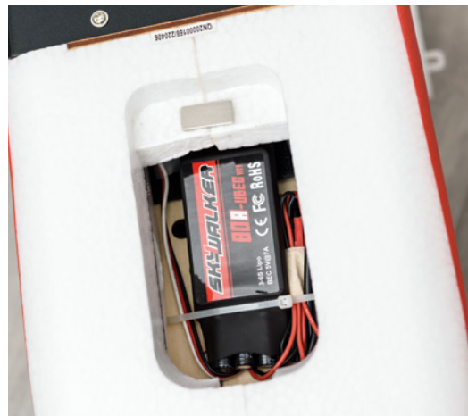
Der 80-Ampere-Regler stammt von Hobbywing. Er wird im Betrieb nur leicht warm
