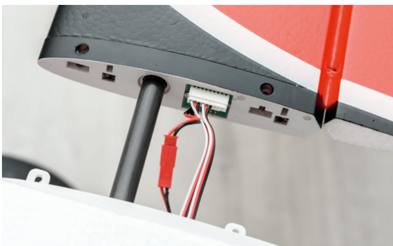
Die elektrische Verbindung zwischen Tragflächen und Rumpf erfolgt über Stecker. Der rote Anschluss ist für die Beleuchtung
