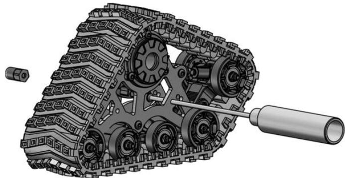
1. Montieren Sie den Dämpferschaft. Beachten Sie, dass die Vorne und Hinten unterschiedlich sind.
