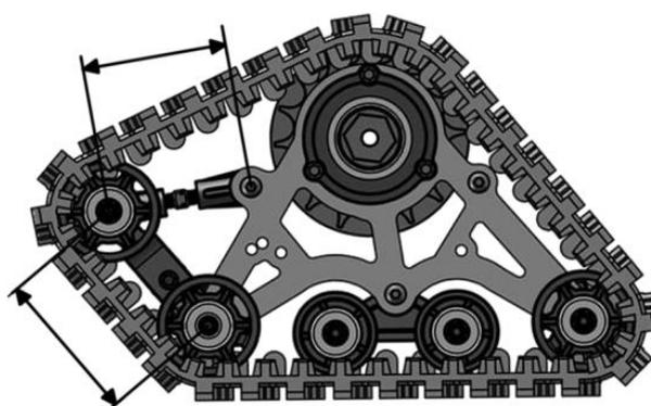
Kettenspannung und Winkeleinstellung: über angezeigte Spur
