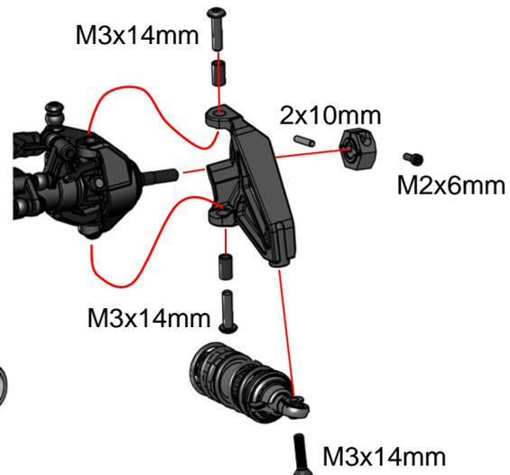
1. Montieren Sie den Dämpferschaft. Beachten Sie, dass die Vorne und Hinten unterschiedlich sind.
