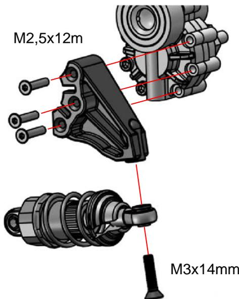
2. Befestigen Sie den Dämpferverbinder (rechts)
