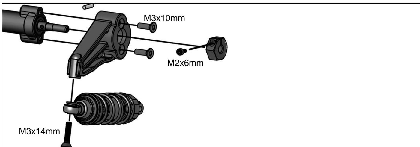
4. Befestigen Sie den Dämpferverbinder (rechts)
