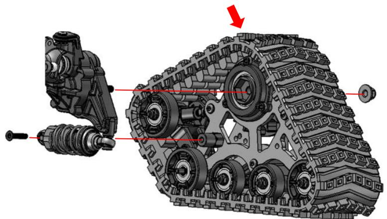
3. Montieren Sie die Kettenräder (rechts)
