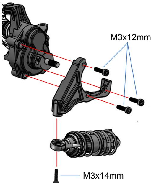
2. Befestigen Sie den Dämpferverbinder (rechts)
