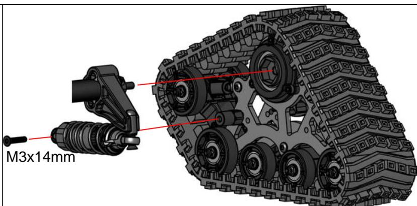
5. Montieren Sie die Kettenräder (rechts)
