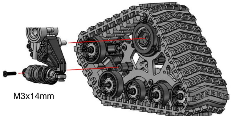
3. Montieren Sie die Kettenräder (rechts)
