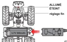
1. Desserrer la vis et retirez le couvercle de la batterie.
