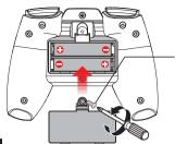
Desserrer la vis et retirez le couvercle de la batterie.
