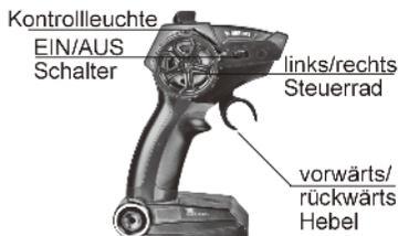
1. Drücken Sie den Hebel der Fernbedienung nach vorne, der Truck fährt vorwärts; Drücken Sie den Hebel nach hinten, fährt der Truck rückwärts; drücken Sie den Hebel bis zur Hälfte nach hinten, wird der Truck langsamer, wenn der Hebel ganz nach hinten gezogen ist, fährt der LKW schnell vorwärts.
