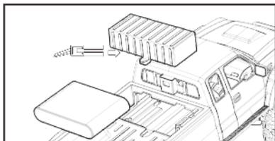
Wenn der Ladevorgang abgeschlossen ist, öffnen Sie das Akkufach und legen Sie den Akku ein.
