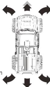
2. Das Steuerad im Uhrzeigersinn drehen, der Wagen fährt nach links; Steuerad gegen den Uhrzeigersinn drehen, der Wagen fährt nach rechts.
