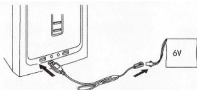
Schließen Sie den Akku an das Ladekabel an, stecken Sie das USB-Ladekabel in den USB-Anschluss des Computers oder des USB-Ladegeräts. Schalten Sie dann die Stromversorgung ein. Wenn die rote LED an ist, bedeutet dies, dass der Ladevorgang läuft, und wenn das rote Licht aus ist, bedeutet dies, dass der Akku vollständig geladen ist.
