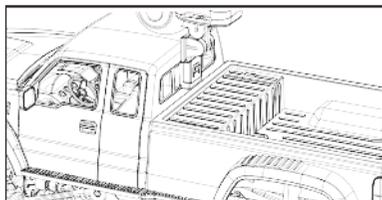
Verbinden Sie den Akku mit der Schnittstelle des Fahrzeugs und schließen Sie die Haube.
